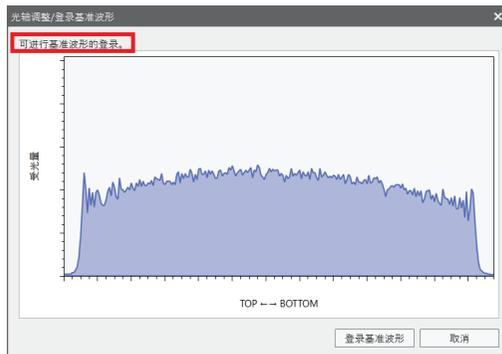
3. 接着如果进行基准波形登录，点击[登录基准波形]后，图表中显示的受光波形将作为基准波形登录。（未进行基准波形登录时，请点击[取消]。返回到主画面。）
