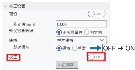
3. 显示校准设定画面。在传感头的投光/受光器之间插入第1个工件，在任意位置点击[固定测量值]。
