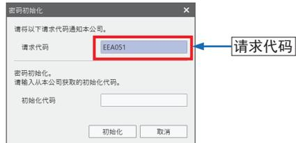
3. 接收初始化代码后，请在密码初始化画面中输入初始化代码。输入代码后点击[初始化]，密码被初始化后，写入防止功能无效。
