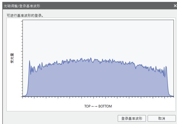
光轴未校准时，波形为“红色”。将在画面右上方显示调整方法。按照对话框内显示的指示，上下左右移动投光器或受光器。
