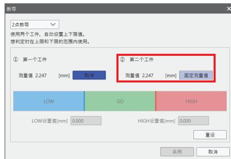
3. 设定HIGH设定值、LOW设定值。以数值输入各设定值，HIGH设定值可调整到LOW设定值的范围，而LOW设定值则可调整到HIGH设定值的范围。
